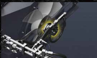
Вентилятор охолодження радіатора гідравлічної рідини
