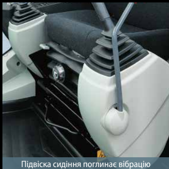
Підвіска сидіння поглинає вібрацію
