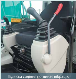
Підвіска сидіння поглинає вібрацію
