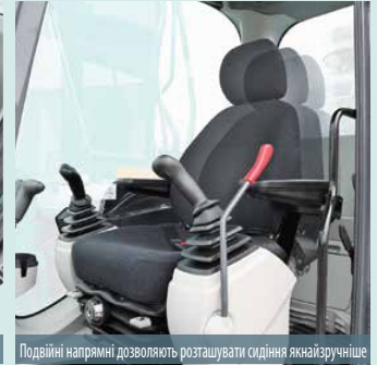
Подвійні напрямні дозволяють розташувати сидіння якнайзручніше
