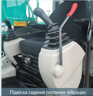
Підвіска сидіння поглинає вібрацію
