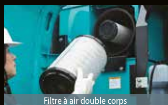
Filtre à air double corps
