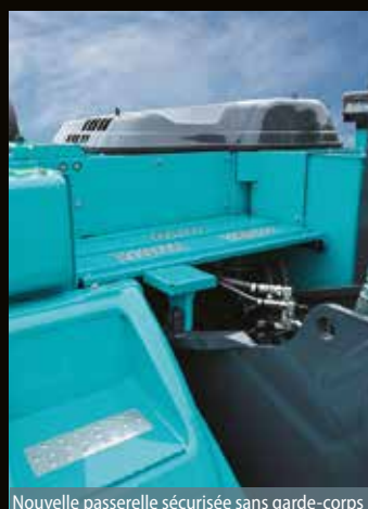
Nouvelle passerelle sécurisée sans garde-corps
