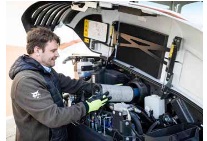
Cambio de los filtros
