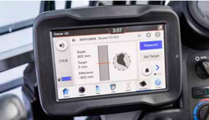
Pantalla táctil de 7 pulgadas con comprobación de profundidad
