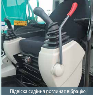
Підвіска сидіння поглинає вібрацію
