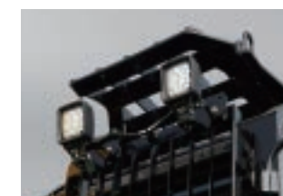
LEDキャブ上ライト 写真のヘッドガード、フロントガードは別オプション
