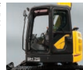
LEDキャブ上ライト 写真のヘッドガード、フロントガードは別オプション
