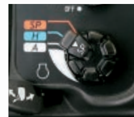
スロットル一体型モード切替機構 ボリュームを回すだけでスロットルが運動、誰でも簡単に最適な作業性能が選択できます。
