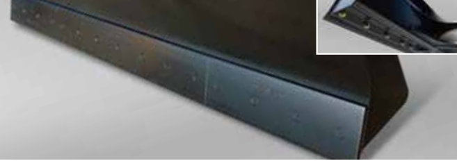
ブレード 写真はボルトオンカuttingエッジ(交換式)タイプ
