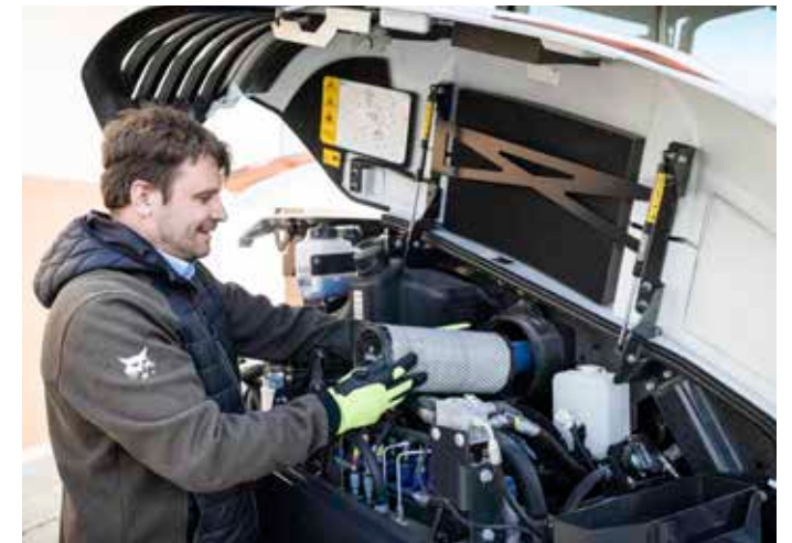
Sostituzione dei filtri
