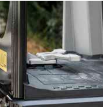
Pedales ergonómicos y plegables de desplazamiento
