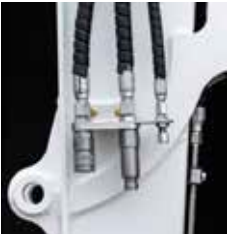
2º AUX hidráulica más tubo de drenaje
