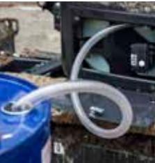
Bomba de rellenado eléctrica
