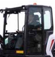
Cabina cerrada TOPS/ROPS/FOPS con calefacción
