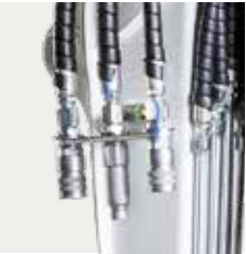
Circuit hydraulique aux. (AUX1) sur le balancier
