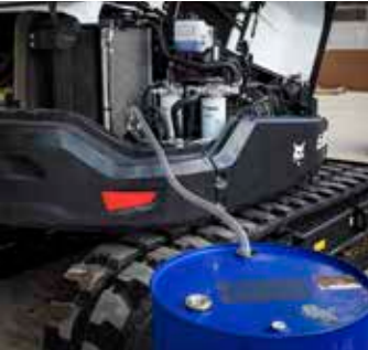
Pompe de ravitaillement en carburant
