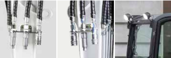
Primer conducto hidráulico AUX en el balancín
